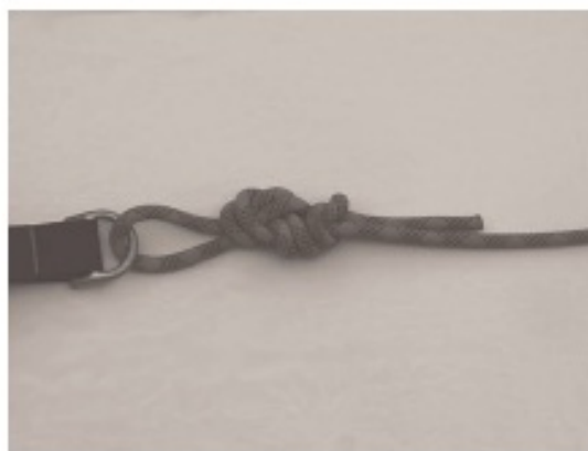
Sicherung mit Speerenstich
